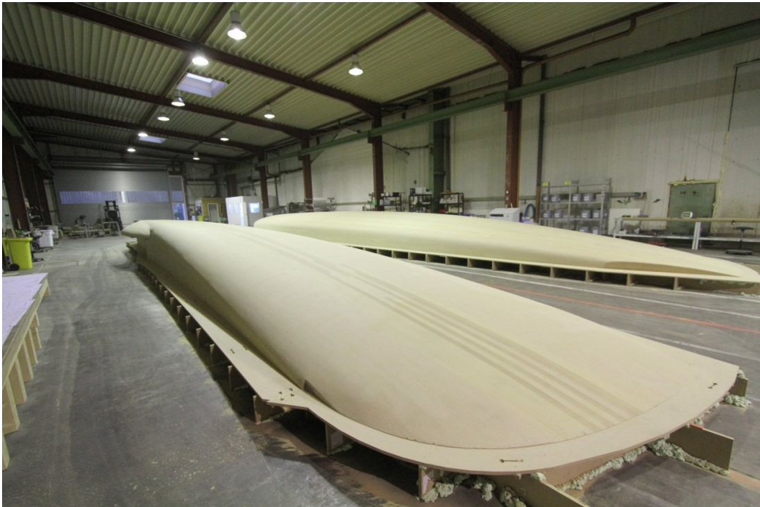
Halbschalen-Positivformen aus gefrästem MDF
