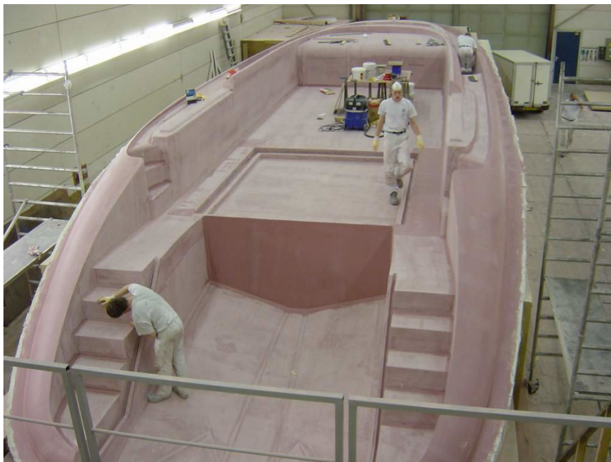
Herstellung einer je aus Schaum gefrästen Urform (oben: Decksaufbau, unten –bereits beschichtet: Rumpf), von der anschließend die Negativform abgenommen wird.
