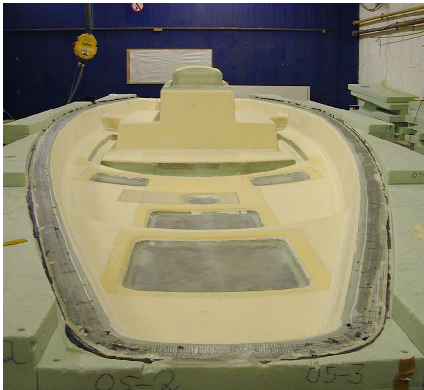
Herstellung einer Negativform für einen 16m langen Decksaufbau einer Segelyacht (oben: per Vakuum-Infusion, unten: gespachtelt und grundiert zur Abformung)
