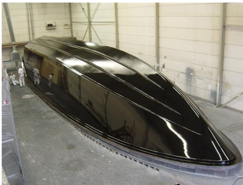
Herstellung einer je aus Schaum gefrästen Urform (oben: Decksaufbau, unten –bereits beschichtet: Rumpf), von der anschließend die Negativform abgenommen wird.
