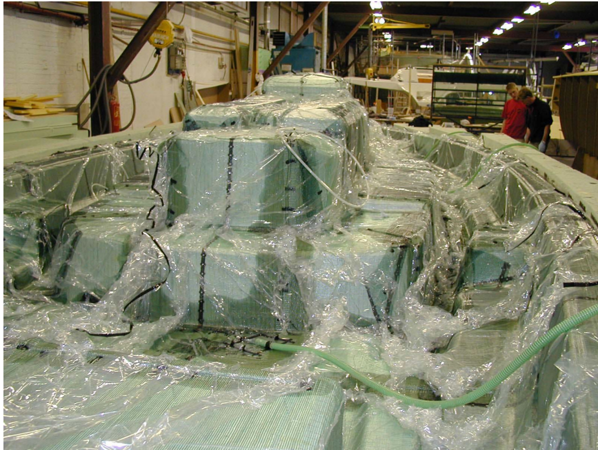
Herstellung einer Negativform für einen 16m langen Decksaufbau einer Segelyacht (oben: per Vakuum-Infusion, unten: gespachtelt und grundiert zur Abformung)
